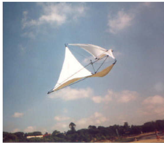
Deformación de la estructura por exceso de viento
